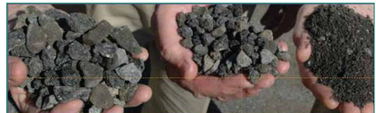
11. ábra: A RAP előkészítése a keverőüzemben való beépítéshez
